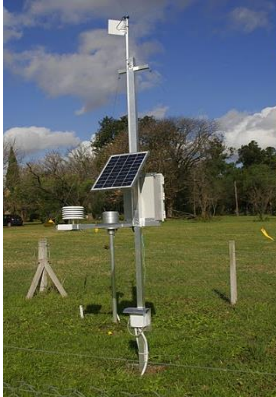
Estación meteorológica Automática 1
